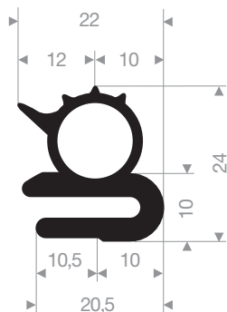
VR21109118 NBR 65° Shore noir longueur du rouleau 25 mètres
