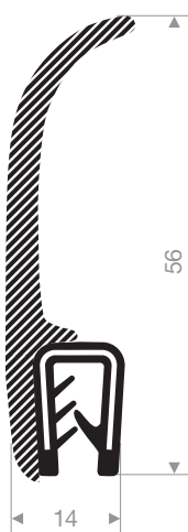
VR24500876 pvc + caoutchouc mousse tôle 1-3 mm longueur du rouleau 25 mètres
