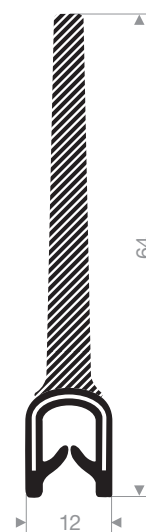
VR24500865 pvc + caoutchouc mousse tôle 1-2,5 mm longueur du rouleau 50 mètres
