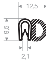
VR24500135 pvc + caoutchouc mousse tôle 1-2 mm longueur du rouleau 50 mètres
