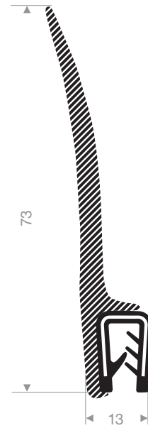
VR24500877 pvc + caoutchouc mousse tôle 1-2 mm longueur du rouleau 25 mètres
