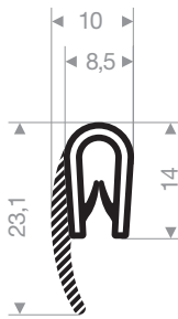
VR24500100 pvc + caoutchouc mousse tôle 1,5-3 mm longueur du rouleau 50 mètres
