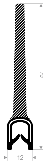
VR24500865 PVC & Moosgummi Spannbereich 1-2,5 mm Rollenlänge 50 Meter
